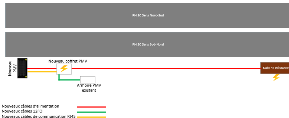
Figure 30 : Synoptique d'implantation - Site 2 - Puymorens
